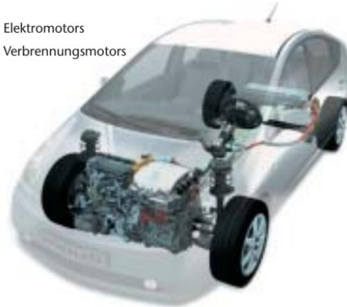
Wird das Fahrzeug angehalten, schaltet sich der Verbrennungsmotor ab.
